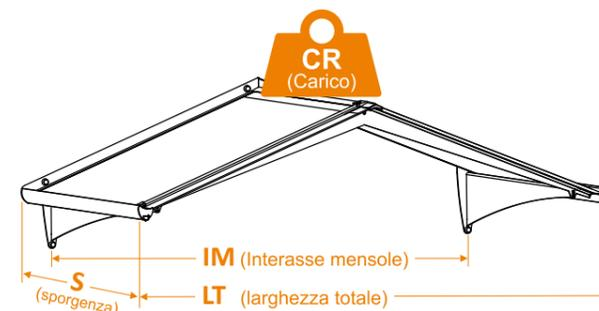
Le pensiline sono fornite di serie per sopportare un carico distribuito certificato di 200 kg/mq. I carichi sono garantiti nelle condizioni di prova come certificate da ISTDIL. La verifica secondo la norma D.M. del 14-01-2008, è a cura dell'installatore.
