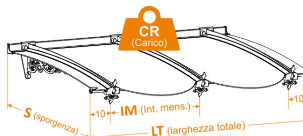
Le pensiline sono fornite di serie per sopportare un carico distribuito certificato di 200 kg/mq. I carichi sono garantiti nelle condizioni di prova come certificate da ISTDIL. La verifica secondo la norma D.M. del 14-01-2008, è a cura dell'installatore.
