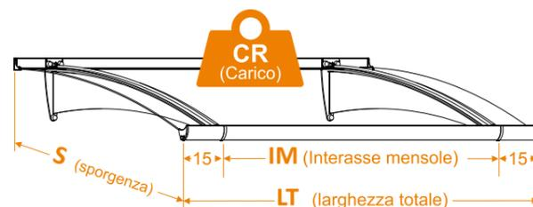
Esclusa la pensilina sporgenza mt. 1,5, il cui carico di 200 kg/mq è su richiesta, tutte le altre pensiline sono fornite di serie per sopportare un carico distribuito certificato di 200 kg/mq. I carichi sono garantiti nelle condizioni di prova come certificate da ISTDIL. La verifica secondo la norma D.M. del 14-01-2008, è a cura dell'installatore.
