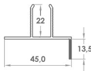
Fornita con doppio foro. Adatta per fissaggio laterale (staccando la linguetta) e frontale
