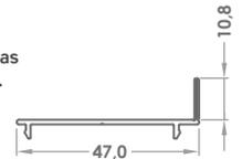
Fornita con doppio foro. Adatta per fissaggio laterale (staccando la linguetta) e frontale
