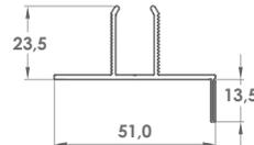
Fornita con doppio foro. Adatta per fissaggio laterale (staccando la linguetta) e frontale
